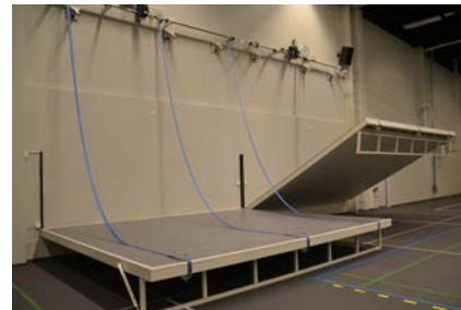
2-osaainen näyttämö, koko 10500 x 4500 mm. Seinällä oleva koneisto voidaan suojata kotelolla, jolloin seinän ulkonäön esteettisyys säilyy. Niemenranta-talo, Oulu.
