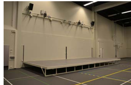
2-osaainen näyttämö, koko 10500 x 4500 mm. Seinällä oleva koneisto voidaan suojata kotelolla, jolloin seinän ulkonäön esteettisyys säilyy. Niemenranta-talo, Oulu.
