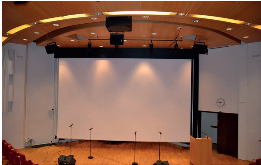
Sähkökäyttöinen valkokangas VK 250, alatukkimalli 7000 x 4800 mm. Kisa-Kino, Saarijärvi.
